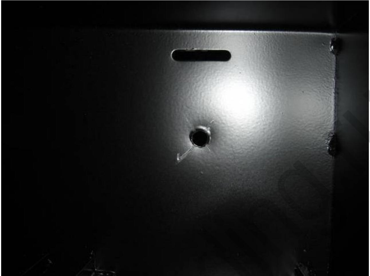
В нишах ящиков для монет и купюр просверлить отверстия для крепления датчиков открытия ящиков.
