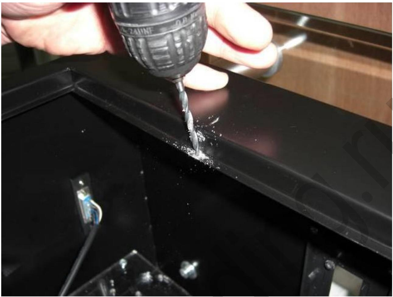
Просверлить отверстие для крепления датчика открытия боковой крышки.
