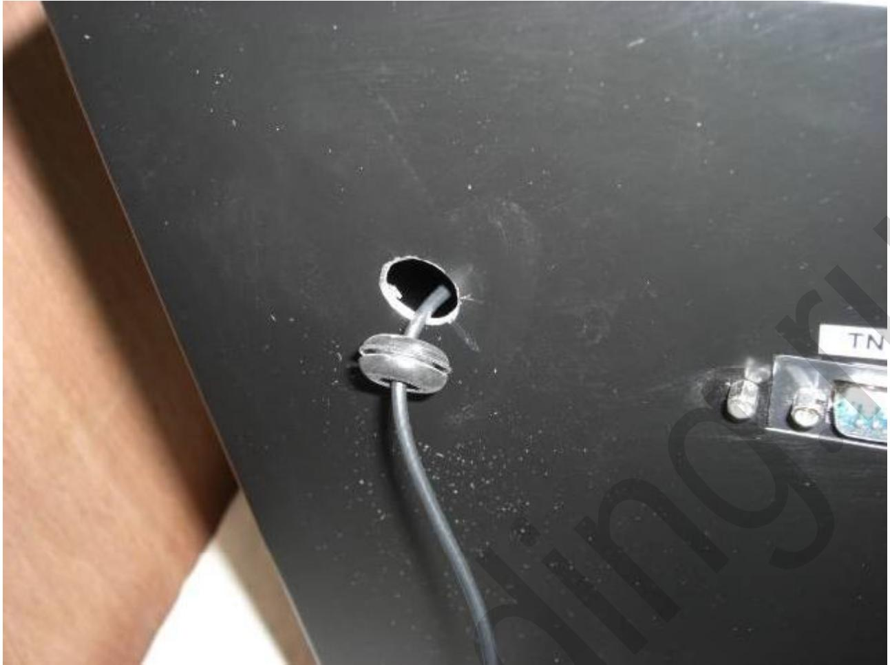
Пропустить антенный провод внутрь платёжного модуля.
