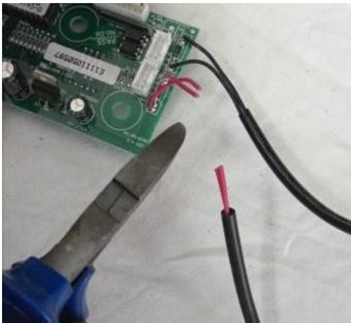
Отрезать провод фискального счётчика.
