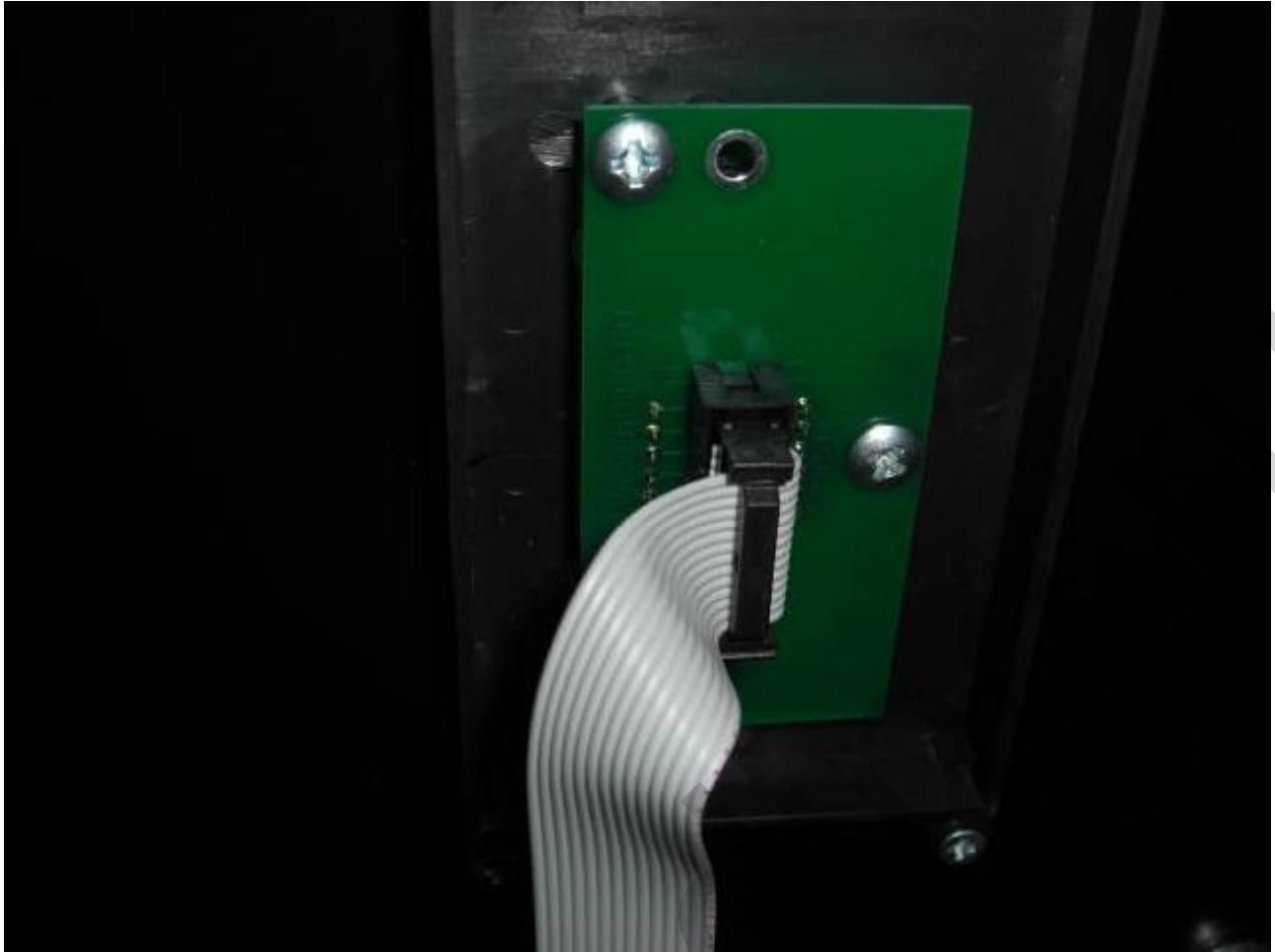
Второй разъём плоского шлейфа включить в разъём на плате индикатора.
