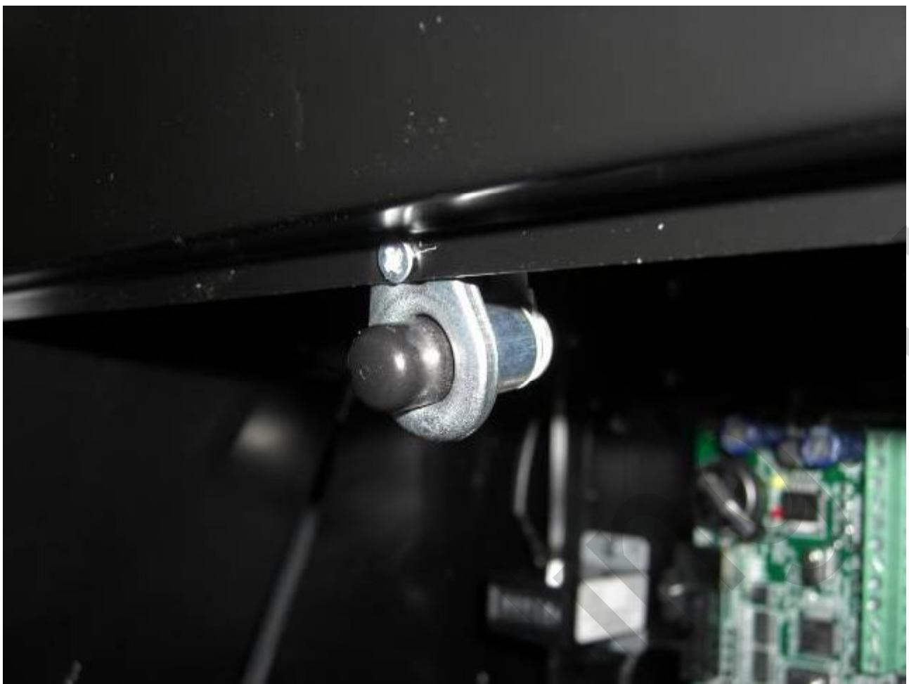
Ещё один датчик открытия закрепить в ранее просверленное отверстие в верхней части платёжного модуля.
