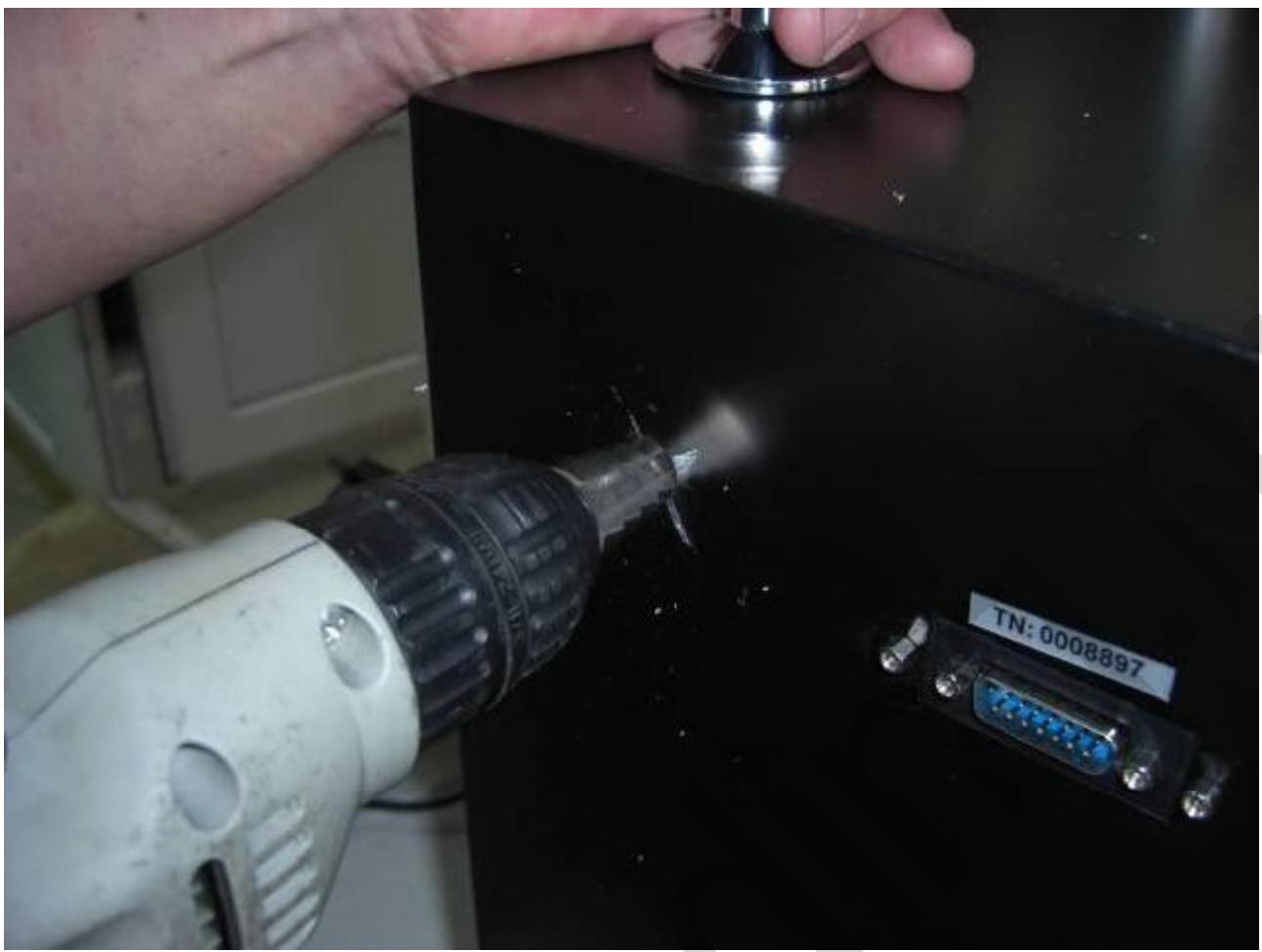
В задней стенке платёжного модуля просверлить отверстие диаметром 14мм.
